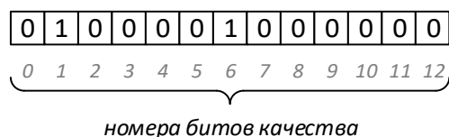
Рисунок 68 – Формат битов качества сигнала
